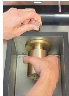
Montage der Lagerhalterung über Snap Closure-Befestigung
