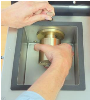
Montage der Lagerhalterung über Snap Closure-Befestigung
