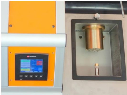
Ein Prüfbecken, automatisiert durch zentrale Steuereinheit
