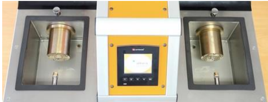
Zwei unabhängig voneinander arbeitende Prüfbecken, automatisiert durch mittig angeordnete zentrale Steuereinheit
